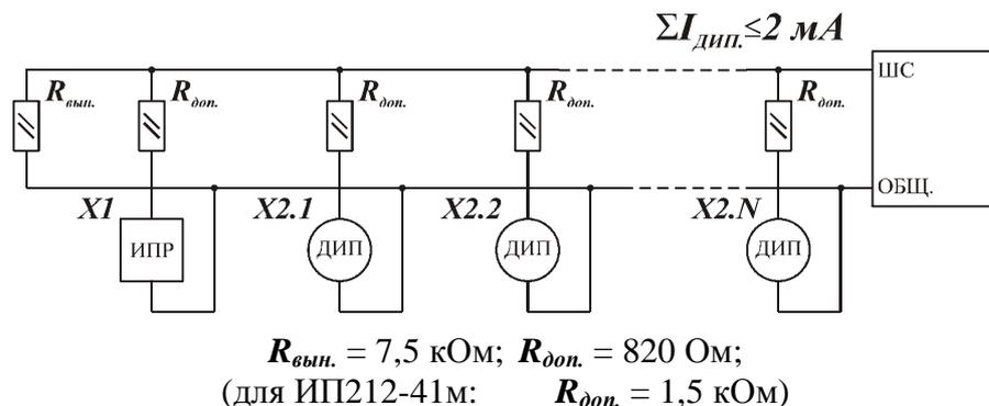
Рис. 1. Схема включения ШС с несколькими дымовыми извещателями (типа ДИП).
