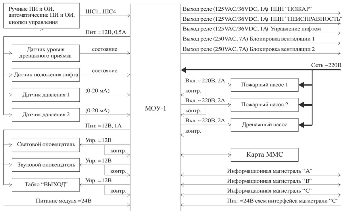
Рис. 3. Структурная схема подключения МОУ-1(МОУ-1-01).
