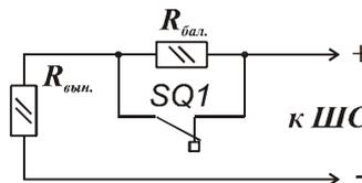
$$R_{вын.} = 7,5 \text{ кОм}; R_{бал.} = 7,5 \text{ кОм};$$
