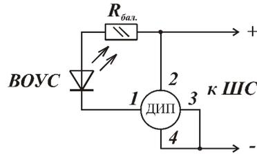
Рис. 4. Схема подключения извещателей типа ДИП с ВУОС.
