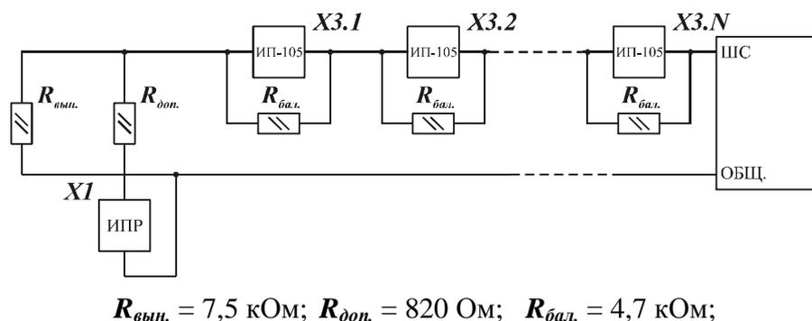
Рис. 2. Схема включения ШС с несколькими тепловыми извещателями (типа ИП-105).
