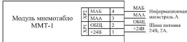
Рис. 8. Схема внешних соединений ММТ-1.
