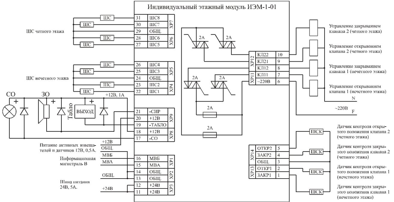
Рис. 5. Схема внешних соединений ИЭМ-1-01.
