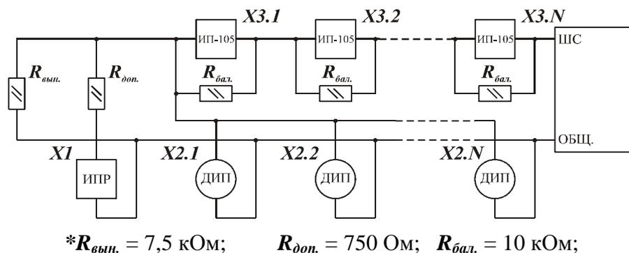
Рис. 3. Комбинированная схема включения ШС со сработкой по одному из извещателей.
