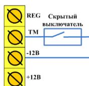
Рис. 10.2. Схема подключения скрытого выключателя
