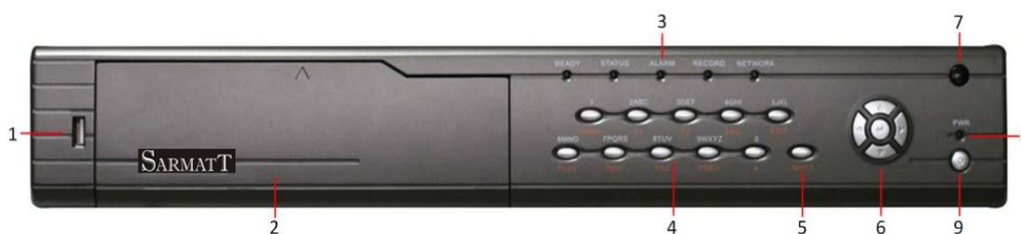
Рис. 10. Передняя панель DSR-1605-rw
