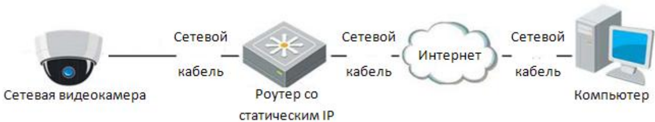
Рисунок 3.1: Доступ к сетевой камере с использованием роутера со статическим IP.
