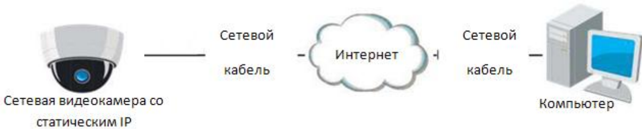
Рисунок 3.2: Доступ к сетевой камере со статическим IP напрямую.
