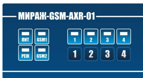
Рис. 3.3. Лицевая панель контроллера
