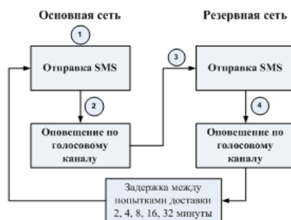
Рис. 4.3. Алгоритм оповещения в режиме автономной охраны
