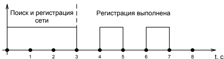
Рис. 3.5. Индикация поиска сети GSM и регистрации в ней
