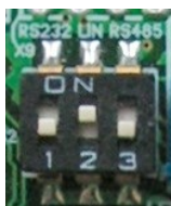
Рис. 7.1. Микропереключатели для выбора типа интеграции
