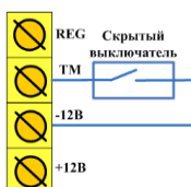
Рис. 10.3. Схема подключения скрытого выключателя
